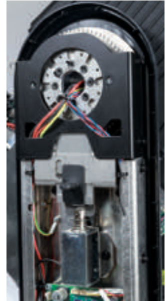
Zugmagnet zur Öffnung der Tilt-Verriegelung
