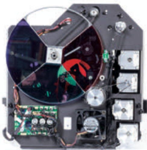
Ein großflächiges Farbrad ist auf der Rückseite des Gobo-Moduls angebracht
