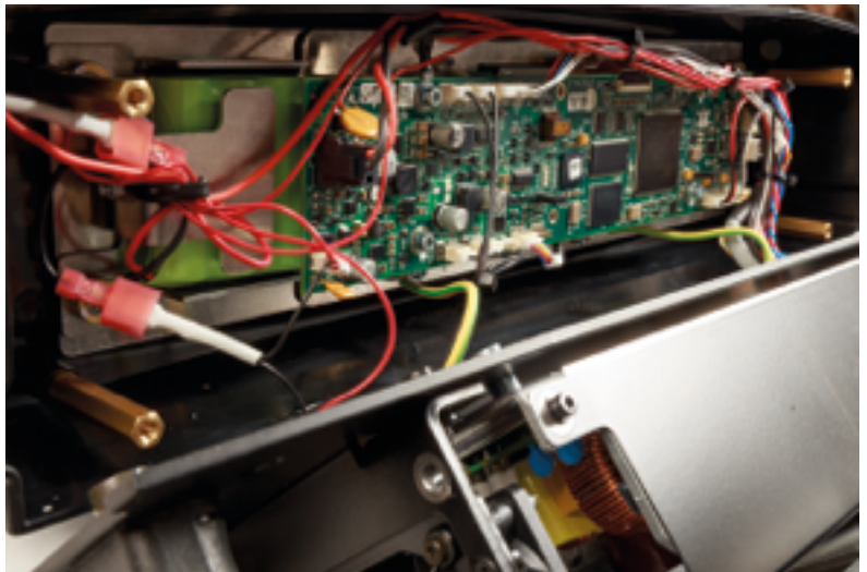
Links vor der Steuerplatine ist der Akku verbaut, der das Menü mit Strom versorgt, wenn der Rhapsodya noch nicht ans Stromnetz angeschlossen ist
