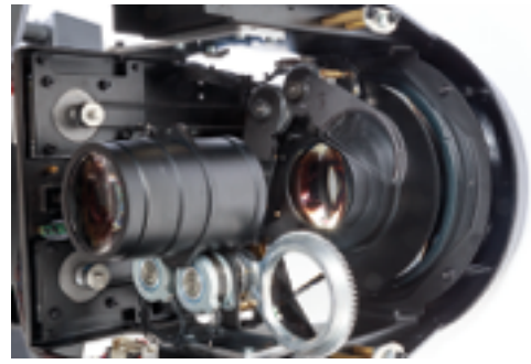
Zoom- und Fokuseinheit mit angehefteten Funktionen Prisma und Frost. eine Lichtblende um die Zoomlinse verdeckt hier im Bild die große Austrittslinse und sorgt dafür, dass seitlich kein Streulicht herausfällt
